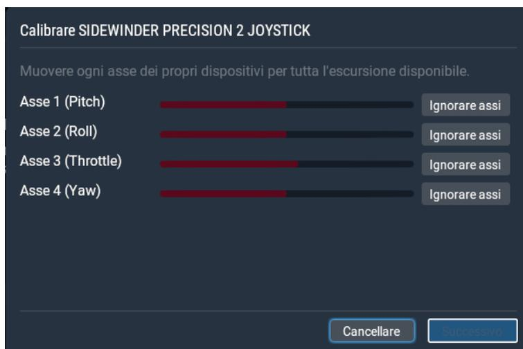
**Figura 2.3:** Finestra di calibrazione per un nuovo Yoke/Joystick
