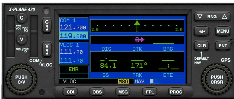
**Figura 7.6:** Il navigatore GPS X-Plane 430 nel Cessna 172.
