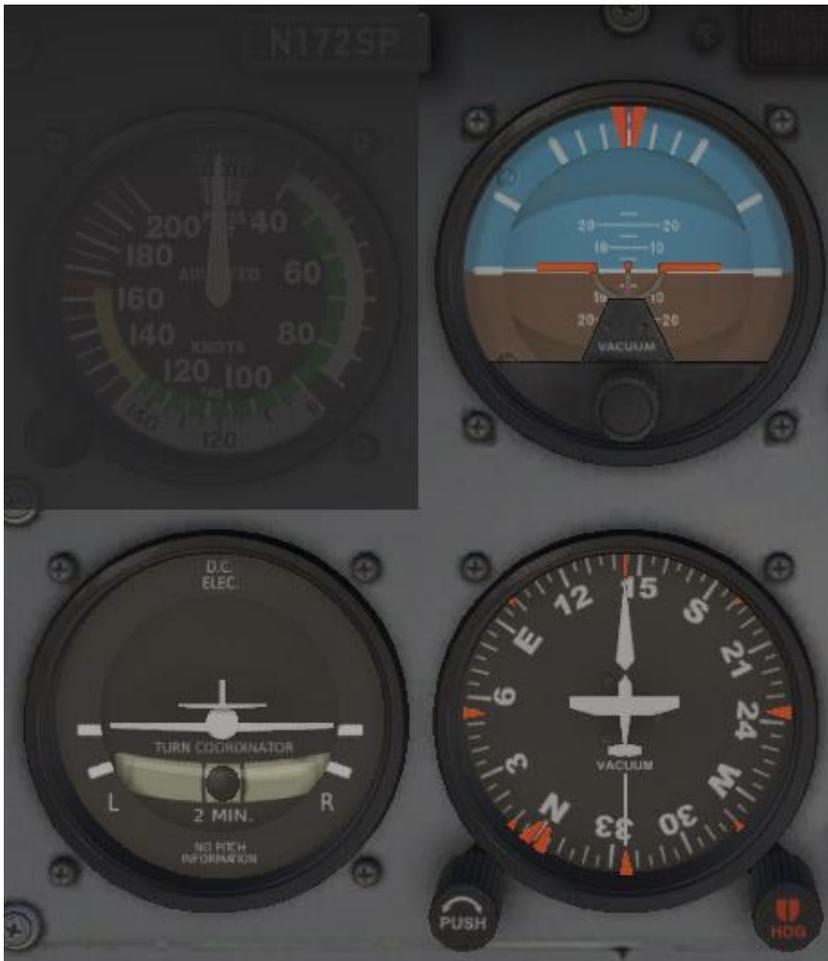
**Figura 7.5:** I tre strumenti giroscopici primari nel Cessna 172
